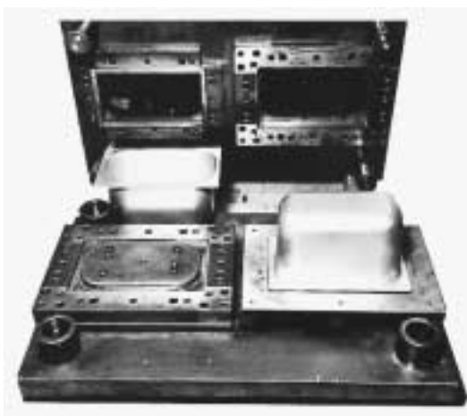
Herramienta de desbarbado y corte de cantos fabricada con Arne para recipientes de chapa de acero inoxidable de 0,914 mm de espesor y unas dimensiones de 254 x 152 x 203 mm.
